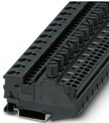
Sicherungsklemme für G-Sicherungseinsatz, Querschnitt: 0,5-10 mm<sup>2</sup>, AWG: 20-8, Breite: 12,2 mm, Farbe: schwarz
