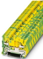
Direktanschluss-Schutzleiterklemme, Anzahl der Anschlüsse: 2, Anschlussart: Schenkelfederanschluss, 1. Etage, Querschnitt: 0,2 mm<sup>2</sup> - 4 mm<sup>2</sup>, Montageart: NS 35/7,5, NS 35/15, Farbe: grün-gelb
