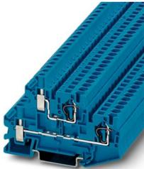
Durchgangsklemme, Nennspannung: 500 V, Nennstrom: 30 A, Anschlussart: Zugfederanschluss, Bemessungsquerschnitt: 4 mm<sup>2</sup>, Querschnitt: 0,08 mm<sup>2</sup> - 6 mm<sup>2</sup>, Anschlussart: Schraubanschluss, Bemessungsquerschnitt: 4 mm<sup>2</sup>, Querschnitt: 0,14 mm<sup>2</sup> - 6 mm<sup>2</sup>, Montage: NS 35/7,5, NS 35/15, Farbe: blau
