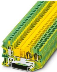
Schutzleiter-Reihenklemme, Anschlussart: Zugfederanschluss, Bemessungsquerschnitt: 2,5 mm<sup>2</sup>, Querschnitt: 0,08 mm<sup>2</sup> - 4 mm<sup>2</sup>, Anschlussart: Schraubanschluss, Bemessungsquerschnitt : 2,5 mm<sup>2</sup>, Querschnitt: 0,14 mm<sup>2</sup> - 4 mm<sup>2</sup>, Montage: NS 35/7,5, NS 35/15, Farbe: grün-gelb
