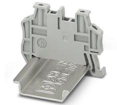
Schnellmontage-Endhalter, Brennbarkeitsklasse V0 nach UL 94, für Tragschiene NS 35/7,5 oder NS 35/15, beschriftbar mit UC-TM 5, UC-TMF 5, KLM 2, KLM3 und KML3L, Parkmöglichkeit für FBS...5, FBS...6, KSS 5, KSS 6, Breite: 5,15 mm, Farbe: grau
