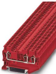
Durchgangsklemme, Nennspannung: 800 V, Nennstrom: 24 A, Anzahl der Anschlüsse: 3, Anschlussart: Zugfederanschluss, Bemessungsquerschnitt: 2,5 mm<sup>2</sup>, Querschnitt: 0,08 mm<sup>2</sup> - 4 mm<sup>2</sup>, Montageart: NS 35/7,5, NS 35/15, Farbe: rot
