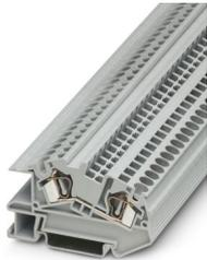
Installationsklemme, Nennspannung: 400 V, Nennstrom: 32 A, Zugfederanschluss, 1. Etage, Bemessungsquerschnitt: 4 mm<sup>2</sup>, Querschnitt: 0,08 mm<sup>2</sup> - 6 mm<sup>2</sup>, Montageart: NS 35/7,5, NS 35/15, Farbe: grau
