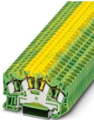
Schutzleiter-Reihenklemme, Anzahl der Anschlüsse: 4, Anschlussart: Zugfederanschluss, 1. Etage, Querschnitt: 0,08 mm<sup>2</sup> - 6 mm<sup>2</sup>, Montageart: NS 35/7,5, NS 35/15, Farbe: grün-gelb
