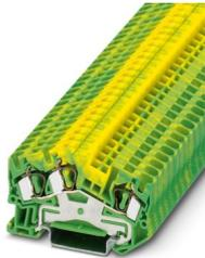
Schutzleiter-Reihenklemme, Anzahl der Anschlüsse: 3, Anschlussart: Zugfederanschluss, 1. Etage, Querschnitt: 0,08 mm<sup>2</sup> - 6 mm<sup>2</sup>, Montageart: NS 35/7,5, NS 35/15, Farbe: grün-gelb
