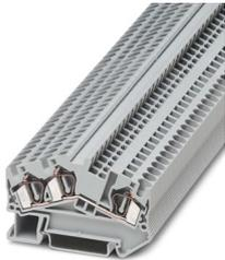
Durchgangsklemme, Nennspannung: 800 V, Nennstrom: 32 A, Anzahl der Anschlüsse: 3, Anschlussart: Zugfederanschluss, Bemessungsquerschnitt: 4 mm<sup>2</sup>, 1. Etage, Querschnitt: 0,08 mm<sup>2</sup> - 6 mm<sup>2</sup>, Montageart: NS 35/7,5, NS 35/15, Farbe: grau
