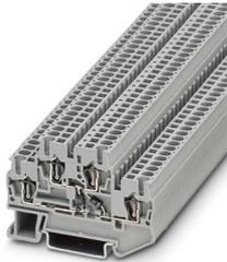
Bauelementreihenklamme, mit integrierter Diode, Nennspannung: 250 V, Nennstrom: 0,5 A, 1. und 2. Etage, Anschlussart: Zugfederanschluss, Bemessungsquerschnitt: 2,5 mm<sup>2</sup>, Querschnitt: 0,08 mm<sup>2</sup> - 4 mm<sup>2</sup>, Montage: NS 35/7,5, NS 35/15, Farbe: grau
