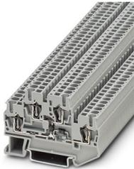
Bauelementreihenkleme, Der max. Strom wird durch die Diode bestimmt. Eingebaut: Diode 1N 4007, Sperrspannung: 1300 V, Dauergrenzstrom: 0,5 A., mit integrierter Diode, Nennstrom: 0,5 A, 1. und 2. Etage, Anschlussart: Zugfederanschluss, Bemessungsquerschnitt: 2,5 mm<sup>2</sup>, Querschnitt: 0,08 mm<sup>2</sup> - 4 mm<sup>2</sup>, Montage: NS 35/7,5, NS 35/15, Farbe: grau
