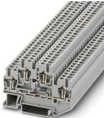
Bauelementreihenkleme, mit eingebauter Diode 1N 5408K, Nennspannung: 500 V, Nennstrom: 1,5 A, 1. und 2. Etage, Anschlussart: Zugfederanschluss, Bemessungsquerschnitt: 2,5 mm<sup>2</sup>, Querschnitt: 0,08 mm<sup>2</sup> - 4 mm<sup>2</sup>, Montage: NS 35/7,5, NS 35/15, Farbe: grau
