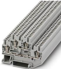
Bauelementreihenklemme, Der max. Strom wird durch die Diode bestimmt. Eingebaut: Diode 1N 4007, Sperrspannung: 1300 V, Dauergrenzstrom: 0,5 A., mit integrierter Diode 1N4007, Nennstrom: 0,5 A, 1. und 2. Etage, Anschlussart: Zugfederanschluss, Bemessungsquerschnitt: 2 ,5 mm<sup>2</sup>, Querschnitt: 0,08 mm<sup>2</sup> - 4 mm<sup>2</sup>, Montage: NS 35/7,5, NS 35/15, Farbe: grau
