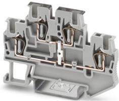
Doppelstock-Zugfederklemme, mit Potenzialverbinder, Nennspannung: 500 V, Nennstrom: 17,5 A, Anschlussart: Zugfederanschluss, 1. und 2. Etage, Bemessungsquerschnitt: 1,5 mm<sup>2</sup>, Querschnitt: 0,08 mm<sup>2</sup> - 1,5 mm<sup>2</sup>, Montageart: NS 35/7,5, NS 35/15, Farbe: grau
