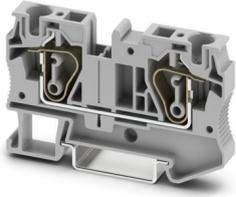
Durchgangsklemme, Nennspannung: 1000 V, Nennstrom: 41 A, Anzahl der Anschlüsse: 2, Anschlussart: Zugfederanschluss, Bemessungsquerschnitt: 6 mm<sup>2</sup>, Querschnitt: 0,2 mm<sup>2</sup> - 10 mm<sup>2</sup>, Montageart: NS 35/7,5, NS 35/15, Farbe: grau
