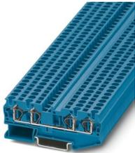
Durchgangsklemme, Nennspannung: 800 V, Nennstrom: 32 A, Anzahl der Anschlüsse: 4, Anschlussart: Zugfederanschluss, Bemessungsquerschnitt: 4 mm<sup>2</sup>, 1. Etage, Querschnitt: 0,08 mm<sup>2</sup> - 6 mm<sup>2</sup>, Montageart: NS 35/7,5, NS 35/15, Farbe: blau
