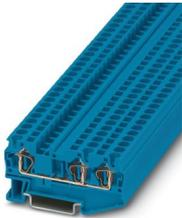
Durchgangsklemme, Nennspannung: 800 V, Nennstrom: 32 A, Anzahl der Anschlüsse: 3, Anschlussart: Zugfederanschluss, Bemessungsquerschnitt: 4 mm<sup>2</sup>, 1. Etage, Querschnitt: 0,08 mm<sup>2</sup> - 6 mm<sup>2</sup>, Montageart: NS 35/7,5, NS 35/15, Farbe: blau
