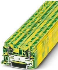
Zugfeder-Schutzleiterklemme, Anzahl der Anschlüsse: 2, Anschlussart: Zugfederanschluss, Bemessungsquerschnitt: 4 mm<sup>2</sup>, Querschnitt: 0,08 mm<sup>2</sup> - 6 mm<sup>2</sup>, Montageart: NS 35/7,5, NS 35/15, Farbe: grün-gelb
