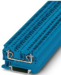
Durchgangsklemme, Nennspannung: 800 V, Nennstrom: 32 A, Anzahl der Anschlüsse: 2, Anschlussart: Zugfederanschluss, Bemessungsquerschnitt: 4 mm<sup>2</sup>, 1. Etage, Querschnitt: 0,08 mm<sup>2</sup> - 6 mm<sup>2</sup>, Montageart: NS 35/7,5, NS 35/15, Farbe: blau
