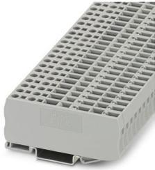
Durchgangsklemme, mit Deckel, Nennspannung: 500 V, Nennstrom: 24 A, Anzahl der Anschlüsse: 4, Anschlussart: Zugfeder- / Steckanschluss, Bemessungsquerschnitt: 2,5 mm<sup>2</sup>, Querschnitt: 0,08 mm<sup>2</sup> - 4 mm<sup>2</sup>, 1. Etage Anschluss links, Montageart: NS 35/7,5, NS 35/15, Farbe: grau
