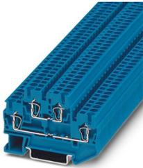
Doppelstock-Zugfederklemme, Nennspannung: 500 V, Nennstrom: 22 A, Anschlussart: Zugfederanschluss, Bemessungsquerschnitt: 2,5 mm<sup>2</sup>, Querschnitt: 0,08 mm<sup>2</sup> - 4 mm<sup>2</sup>, Montageart: NS 35/7,5, NS 35/15, Farbe: blau
