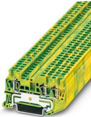
Schutzleiter-Reihenklemme, Anzahl der Anschlüsse: 3, Anschlussart: Zugfederanschluss, Bemessungsquerschnitt: 2,5 mm<sup>2</sup>, Querschnitt: 0,08 mm<sup>2</sup> - 4 mm<sup>2</sup>, Montageart: NS 35/7,5, NS 35/15, Farbe: grün-gelb
