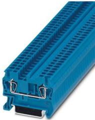
Durchgangsklemme, Nennspannung: 800 V, Nennstrom: 24 A, Anzahl der Anschlüsse: 2, Anschlussart: Zugfederanschluss, Bemessungsquerschnitt: 2,5 mm<sup>2</sup>, Querschnitt: 0,08 mm<sup>2</sup> - 4 mm<sup>2</sup>, Montageart: NS 35/7,5, NS 35/15, Farbe: blau
