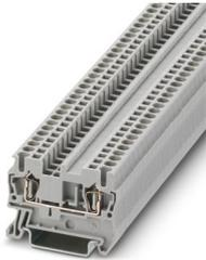
Durchgangsklemme, Nennspannung: 800 V, Nennstrom: 24 A, Anzahl der Anschlüsse: 2, Polzahl: 1, Anschlussart: Zugfederanschluss, Bemessungsquerschnitt: 2,5 mm<sup>2</sup>, Querschnitt: 0,08 mm<sup>2</sup> - 4 mm<sup>2</sup>, Montageart: NS 35/7,5, NS 35/15, Farbe: grau
