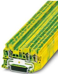
Schutzleiter-Reihenklemme, Anzahl der Anschlüsse: 3, Anschlussart: Zugfederanschluss, Bemessungsquerschnitt: 1,5 mm<sup>2</sup>, Querschnitt: 0,08 mm<sup>2</sup> - 1,5 mm<sup>2</sup>, Montageart: NS 35/7,5, NS 35/15, Farbe: grün-gelb
