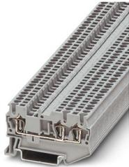
Durchgangsklemme, Nennspannung: 500 V, Nennstrom: 17,5 A, Anzahl der Anschlüsse: 3, Anschlussart: Zugfederanschluss, Bemessungsquerschnitt: 1,5 mm<sup>2</sup>, Querschnitt: 0,08 mm<sup>2</sup> - 1,5 mm<sup>2</sup>, Montageart: NS 35/7,5, NS 35/15, Farbe: grau
