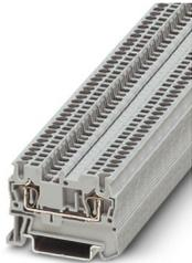
Durchgangsklemme, Nennspannung: 500 V, Nennstrom: 17,5 A, Anzahl der Anschlüsse: 2, Anschlussart: Zugfederanschluss, Bemessungsquerschnitt: 1,5 mm<sup>2</sup>, 1. Etage, Querschnitt: 0,08 mm<sup>2</sup> - 1,5 mm<sup>2</sup>, Montageart: NS 35/7,5, NS 35/15, Farbe: grau
