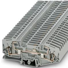
Messwandler-Trennklemme, mit Gleitsteg, Nennspannung: 400 V, Nennstrom: 41 A, 1. Etage, Anschlussart: Zugfederanschluss, Bemessungsquerschnitt: 6 mm<sup>2</sup>, Querschnitt: 0,2 mm<sup>2</sup> - 10 mm<sup>2</sup>, Montage: NS 35/7,5, NS 35/15, Farbe: grau
