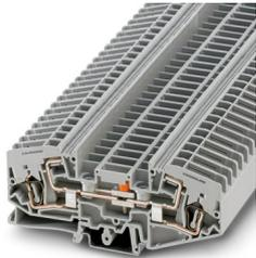
Messwandler-Trennklemme, Nennspannung: 400 V, Nennstrom: 41 A, Anschlussart: Zugfederanschluss, 1. Etage, Bemessungsquerschnitt: 6 mm<sup>2</sup>, Querschnitt: 0,2 mm<sup>2</sup> - 10 mm<sup>2</sup>, Farbe: grau
