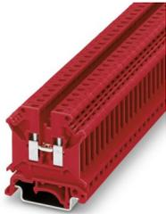
Durchgangsklemme, Nennspannung: 800 V, Nennstrom: 32 A, Anzahl der Anschlüsse: 2, Anschlussart: Schraubanschluss, Bemessungsquerschnitt: 4 mm<sup>2</sup>, Querschnitt: 0,2 mm<sup>2</sup> - 6 mm<sup>2</sup>, Montageart: NS 35/7,5, NS 35/15, NS 32, Farbe: rot
