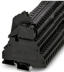
Sicherungsreihenklemme, Art der Sicherung: Glas / Keramik / ..., Sicherungstyp: G / 5 x 20, Nennspannung: 24 V, Nennstrom: 32 A, Anschlussart: Schraubanschluss, Querschnitt: 0,2 mm<sup>2</sup>- 4 mm<sup>2</sup>, Bemessungsquerschnitt: 1,5 mm<sup>2</sup>, Montageart: NS 35/7,5, NS 35/15, NS 32, Farbe: schwarz
