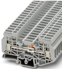
Messwandler-Trennklemme, Nennspannung: 500 V, Nennstrom: 41 A, Anschlussart: Schraubanschluss, 1. Etage, Bemessungsquerschnitt: 6 mm<sup>2</sup>, Querschnitt: 0,5 mm<sup>2</sup> - 10 mm<sup>2</sup>, Montageart: NS 35/7,5, NS 35/15, NS 32, Farbe: grau
