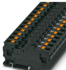
Sicherungsreihenklemme, Art der Sicherung: Glas / Keramik / ..., Sicherungstyp: G / 5 x 20, Nennspannung: 250 V, Nennstrom: 10 A, Anschlussart: Push-in-Anschluss, Bemessungsquerschnitt: 6 mm<sup>2</sup>, Querschnitt: 0,5 mm<sup>2</sup>- 10 mm<sup>2</sup>, Montageart: NS 35/7,5, NS 35/15, Farbe: schwarz
