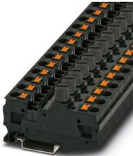
Sicherungsreihenklemme, Art der Sicherung: Glas / Keramik / ..., Sicherungstyp: G / 5 x 20, Nennspannung: 1000 V, Nennstrom: 10 A, Anschlussart: Push-in-Anschluss, Bemessungsquerschnitt: 6 mm<sup>2</sup>, Querschnitt: 0,5 mm<sup>2</sup>- 10 mm<sup>2</sup>, Montageart: NS 35/7,5, NS 35/15, Farbe: schwarz
