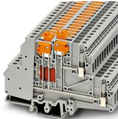
Messertrennklemme, mit Prüfbuchschrauben zur Aufnahme von Prüfsteckern, Nennspannung: 400 V, Nennstrom: 10 A, 1. und 2. Etage, Anschlussart: Schraubanschluss, Bemessungsquerschnitt: 4 mm<sup>2</sup>, Querschnitt: 0,2 mm<sup>2</sup> - 4 mm<sup>2</sup>, 2. Etage, Anschlussart: Schraubanschluss, Bemessungsquerschnitt: 4 mm<sup>2</sup>, Querschnitt: 0,2 mm<sup>2</sup> - 4 mm<sup>2</sup>, Montage: NS 35/7,5, NS 35/15, NS 32, Farbe: grau
