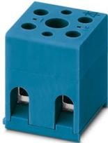
Geräteklemme, mit integrierter Diode, Nennspannung: 500 V, Nennstrom: 32 A, Anzahl der Anschlüsse: 4, Anschlussart: Schraubanschluss, Querschnitt: 0,2 mm<sup>2</sup> - 4 mm<sup>2</sup>, Montageart: direktes Anschrauben, Farbe: blau
