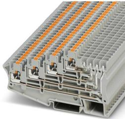
Mehrstockklemme, Nennspannung: 250 V, Nennstrom: 10 A, Anzahl der Anschlüsse: 8, Anschlussart: Push-in- / Steckanschluss, Bemessungsquerschnitt: 2,5 mm<sup>2</sup>, Querschnitt: 0,14 mm<sup>2</sup> - 4 mm<sup>2</sup>, Montageart: NS 35/7,5, NS 35/15, Farbe: grau
