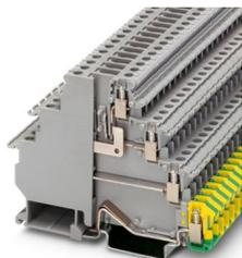
Installations-Schutzleiterklemme, Strom und Spannung werden durch den eingesetzten Stecker bestimmt., Nennspannung: 250 V, Nennstrom: 24 A, Anschlussart: Schraubanschluss, 2., 3., und 4. Etage, Bemessungsquerschnitt: 2,5 mm<sup>2</sup>, Querschnitt: 0,2 mm<sup>2</sup> - 4 mm<sup>2</sup>, Anschlussart: Schraubanschluss, Bemessungsquerschnitt: 1,5 mm<sup>2</sup>, Querschnitt: 0,2 mm<sup>2</sup> - 4 mm<sup>2</sup>, Montageart: NS 35/7,5, NS 35/15, Farbe: grau
