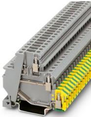
Initiatoren-/Aktorenklemme, Strom und Spannung werden durch den eingesetzten Stecker bestimmt., Nennspannung: 250 V, Nennstrom: 24 A, Anschlussart: Schraubanschluss, Bemessungsquerschnitt: 2,5 mm<sup>2</sup>, Querschnitt: 0,2 mm<sup>2</sup> - 4 mm<sup>2</sup>, Anschlussart: Schraubanschluss, Querschnitt: 0,2 mm<sup>2</sup> - 4 mm<sup>2</sup>, Montage: NS 35/7,5, NS 35/15, Farbe: grau
