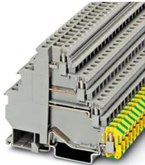
Reihenklemme, Nennspannung: 400 V, Nennstrom: 19 A, Anschlussart: Schraubanschluss, Bemessungsquerschnitt: 2,5 mm<sup>2</sup>, Querschnitt: 0,2 mm<sup>2</sup> - 4 mm<sup>2</sup>, Montageart: NS 35/7,5, NS 35/15, Farbe: grau
