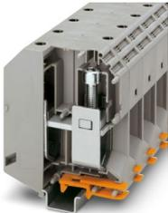
Hochstromklemme, Nennspannung: 1000 V, Nennstrom: 415 A, Anzahl der Anschlüsse: 2, Anschlussart: Schraubanschluss, Bemessungsquerschnitt: 240 mm<sup>2</sup>, Querschnitt: 70 mm<sup>2</sup> - 240 mm<sup>2</sup>, Montageart: NS 35/15, NS 32, Farbe: grau
