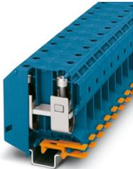
Hochstromklemme, Nennspannung: 1000 V, Nennstrom: 232 A, Anzahl der Anschlüsse: 2, Polzahl: 1, Anschlussart: Schraubanschluss, Bemessungsquerschnitt: 95 mm<sup>2</sup>, Querschnitt: 25 mm<sup>2</sup> - 95 mm<sup>2</sup>, Montageart: NS 35/15, NS 32, NS 35/15-2,3, Farbe: blau
