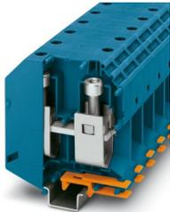
Hochstromklemme, Nennspannung: 1000 V, Nennstrom: 309 A, Anzahl der Anschlüsse: 2, Polzahl: 1, Anschlussart: Schraubanschluss, Querschnitt: 35 mm<sup>2</sup> - 150 mm<sup>2</sup>, Montageart: NS 35/15, NS 32, Farbe: blau
