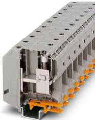
Hochstromklemme, Nennspannung: 1000 V, Nennstrom: 232 A, Anzahl der Anschlüsse: 2, Anschlussart: Schraubanschluss, Bemessungsquerschnitt: 95 mm<sup>2</sup>, Querschnitt: 25 mm<sup>2</sup> - 95 mm<sup>2</sup>, Montageart: NS 35/15, NS 32, Farbe: grau
