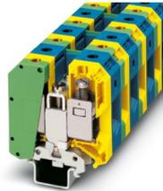
Installations-Schutzleiterklemme, PE/N-Block, bestehend aus einer grün-gelben Schutzleiterklemme und einer blauen Reihenklemme mit Schraubbrücke, Nennspannung: 1000 V, Nennstrom: 150 A, Schraubanschluss, Bemessungsquerschnitt: 50 mm<sup>2</sup>, Querschnitt: 16 mm<sup>2</sup> - 50 mm<sup>2</sup>, Montageart: NS 35/7,5, NS 35/15, NS 32, Farbe: grün-gelb
