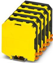
Hochstromklemme, mit Innensechskantschrauben, Nennspannung: 1000 V, Nennstrom: 150 A, Anzahl der Anschlüsse: 2, Polzahl: 1, Anschlussart: Schraubanschluss, Querschnitt: 16 mm<sup>2</sup> - 70 mm<sup>2</sup>, Montageart: NS 35/7,5, NS 35/15, NS 32, NS 35/15-2,3, Farbe: schwarz/gelb
