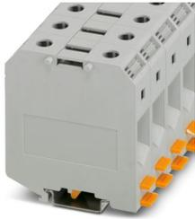
Hochstromklemme, mit Innensechskantschrauben, Nennspannung: 1000 V, Nennstrom: 150 A, Anzahl der Anschlüsse: 2, Polzahl: 1, Anschlussart: Schraubanschluss, Querschnitt: 16 mm<sup>2</sup> - 70 mm<sup>2</sup>, Montageart: NS 35/7,5, NS 35/15, NS 32, NS 35/15-2,3, Farbe: grau
