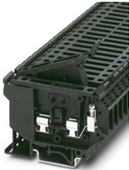
Sicherungsreihenklemme, Art der Sicherung: Glas / Keramik / ..., Sicherungstyp: G / 5 x 20 / 5 x 25 / 5 x 30, Nennspannung: 800 V, Nennstrom: 6,3 A, Polzahl: 1, Anschlussart: Schraubanschluss, Bemessungsquerschnitt: 4 mm<sup>2</sup>, Querschnitt: 0,2 mm<sup>2</sup>- 4 mm<sup>2</sup>, Montageart: NS 35/7,5, NS 35/15, NS 32, Farbe: grau
