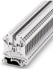
Durchgangsklemme, Nennspannung: 800 V, Nennstrom: 32 A, Anzahl der Anschlüsse: 2, Anschlussart: Schraubanschluss, Bemessungsquerschnitt: 4 mm<sup>2</sup>, Querschnitt: 0,2 mm<sup>2</sup> - 6 mm<sup>2</sup>, Montageart: NS 35/7,5, NS 35/15, NS 32, Farbe: weiß
